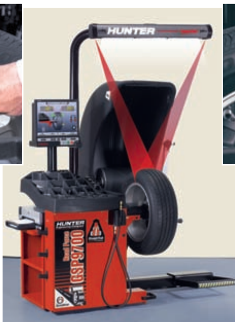
Лазерный указатель HammerHead проецирует метку в верхнюю точку обода колеса (BMT), что исключает ошибки при установке набивного груза.
