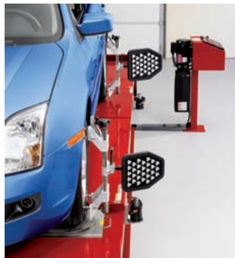
Для измерительной системы HawkEye разработаны небольшие и легкие колесные мишени высокого разрешения.
