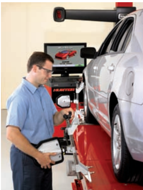
Для измерительной системы HawkEye разработаны небольшие и легкие колесные мишени высокого разрешения.
