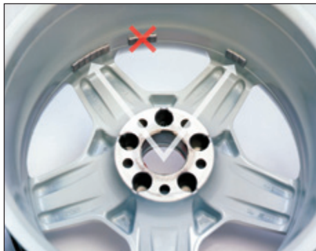
Программой предусмотрены различные варианты монтажа клеевых грузов, в том числе их разделение и установка за спицами диска.
