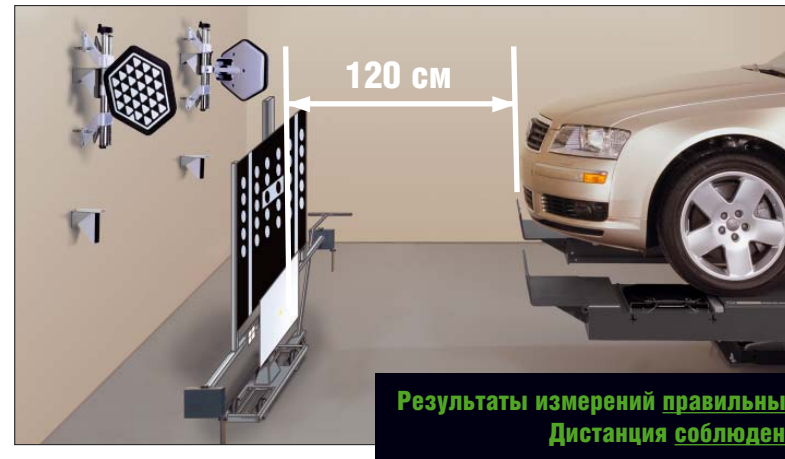
Процедура регулировки ADR при использовании опциональных датчиков HS401.
