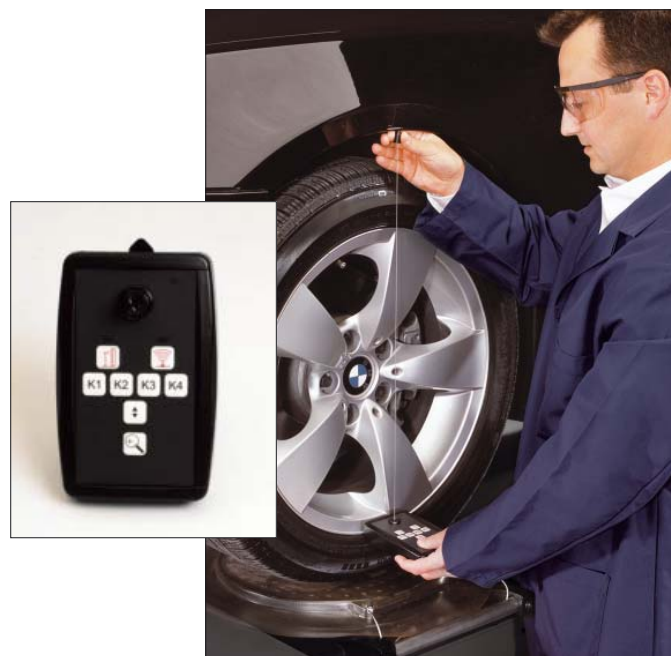
Электронный измеритель высоты посадки, номер по каталогу 20-1885-1, выполнив измерения передаёт их на консоль одним нажатием кнопки.
