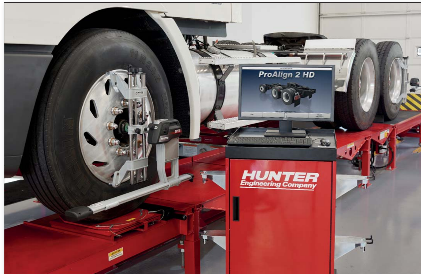
Hunter PT210E с датчиками DSP740T и 24" ЖК монитором
